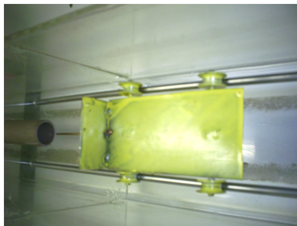
Figura 2 – Orificio de descarga y placa móvil
