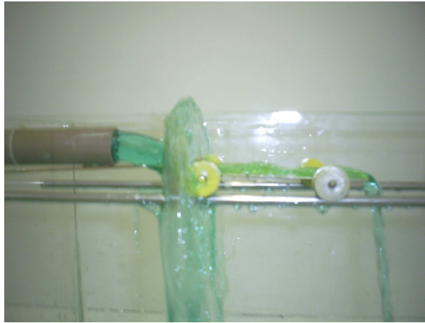
Figura 3 – Masa de fluido que desplaza la placa móvil
