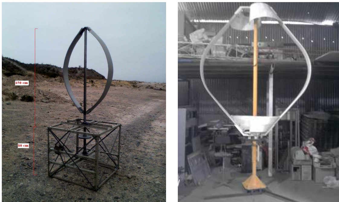
Figura 1: Modelo de Turbina Darrieus Troposkien ensayado en la UNLP (izquierda) [5] - Prototipo de Turbina Darrieus Troposkien de 5kW (derecha) [6].
