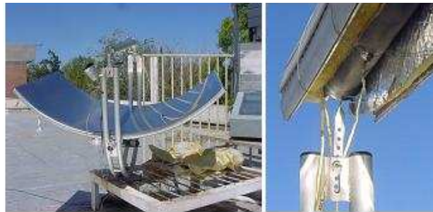
Figura 3 Vista del CPL y el absorbedor con aislación térmica durante el ensayo experimental
