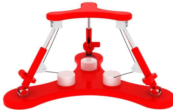
Fig. 9 Esquema de manipulador 3RPS con sistema de medición de longitud de piernas
