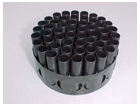
Figura 2. 3 er prototipo separador elástico CARA.
