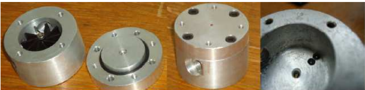
Figura 2 - Transdutor de vazão tipo turbina.
