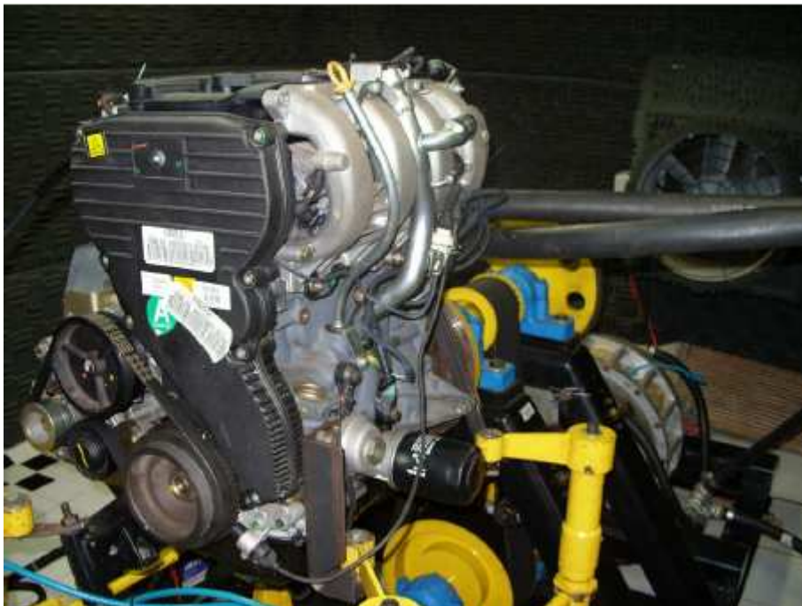
Figura 6 - Motor FIAT 1.6 16V em bancada.
