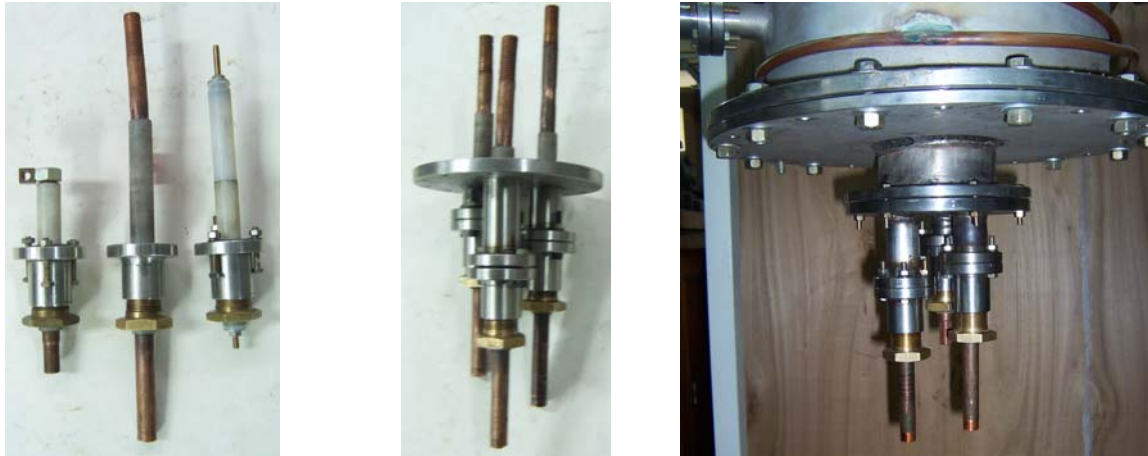
Figura 4 Tipos de terminales e instalación en inferior de cámara de vacío.
