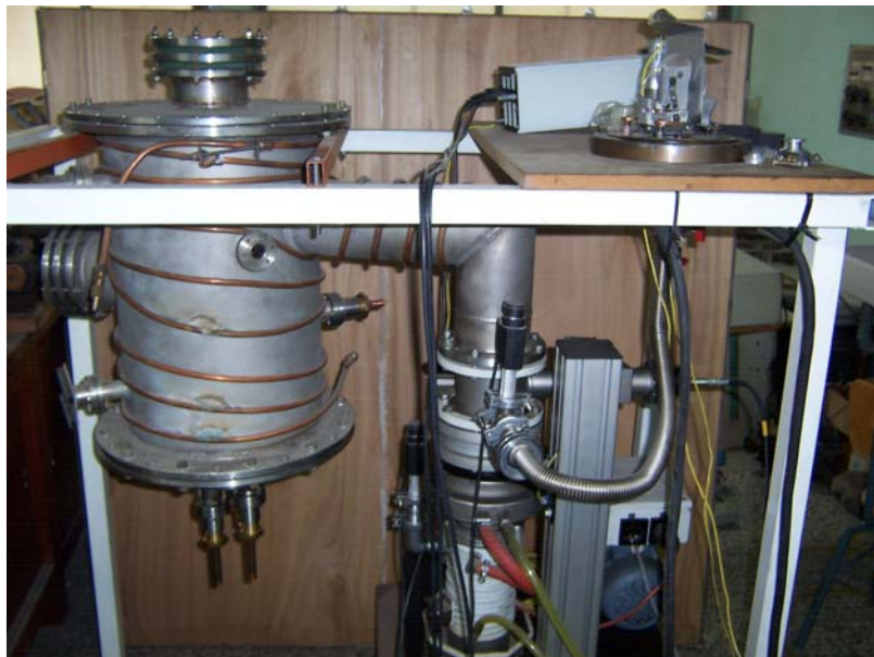
Figura 1 Instalación completa de cámara y bomba de alto vacío.
