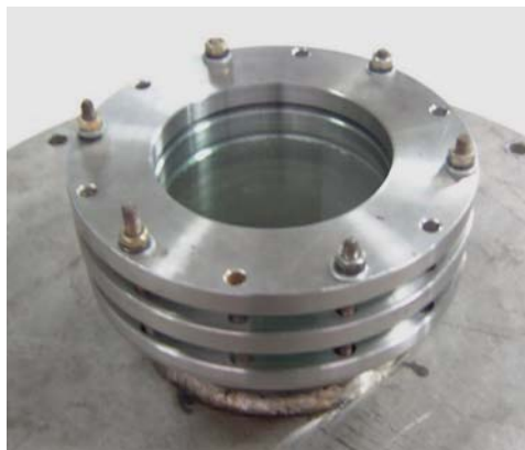
Figura 5 Conjunto doble vidrio-aro formando la mirilla superior.
