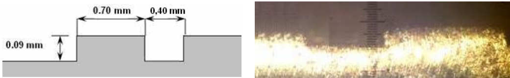
Figura 3. Esquema y micrografía del perfil 2 impreso
