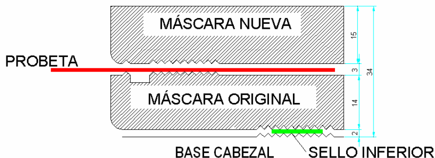
Figura 4 . Esquema del montaje de las máscaras elípticas original y nueva en el cabezal.
