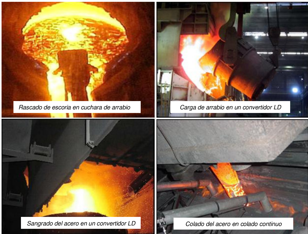
Figura 1 - Flujo de fluido presente en la elaboración y colado del acero
