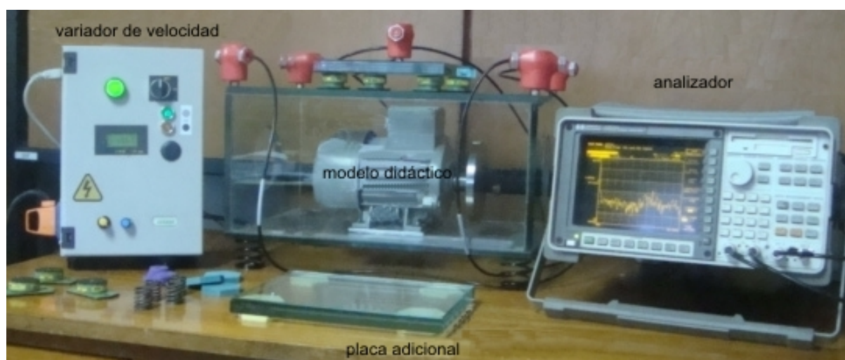
Figura 1: Modelo didáctico construido para realizar mediciones de vibraciones en múltiples grados de libertad
