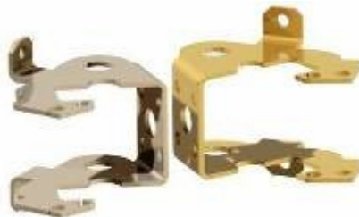
Figura 4 Bisagra creada en el entorno de Chapa. (Solid Edge V17 ©).
