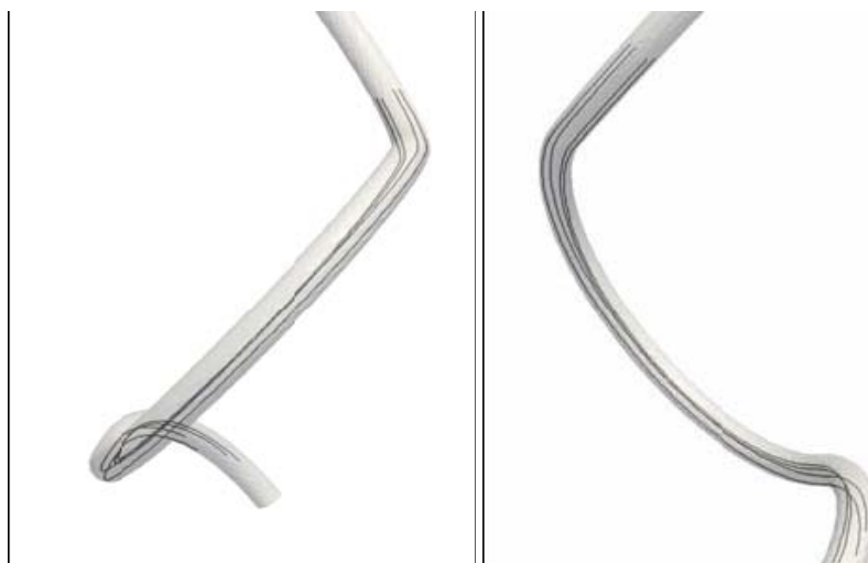
Figura 4 Líneas de corriente del flujo en la arteria
