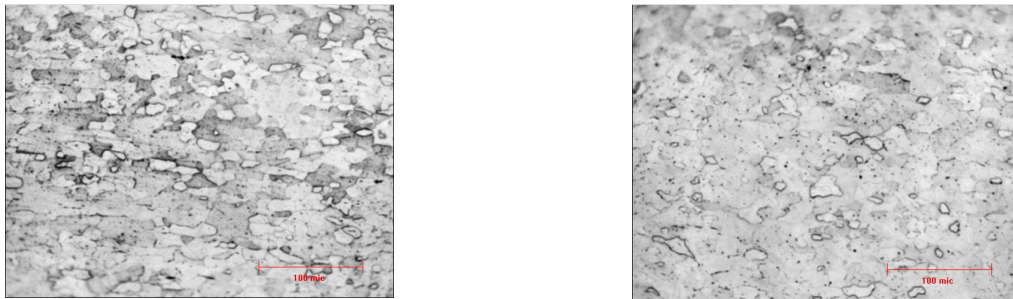
Figura 1: a) Microestructura en el plano paralelo de la chapa; b) en el plano normal de la chapa
