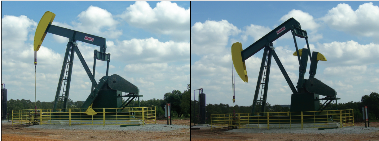
Figura 2: Acción del cable sobre la cabeza. Izq: cable apoyado sobre la cabeza; Der: cable soportado sólo por el anclaje
