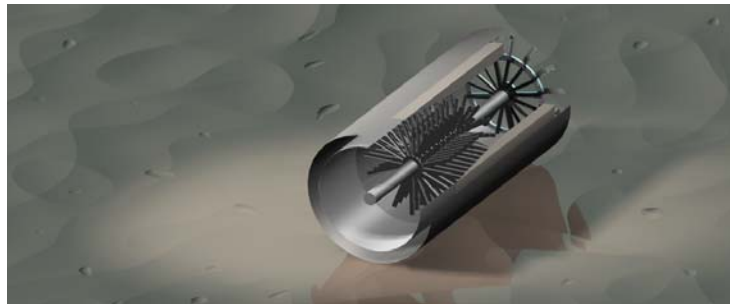
Figura 1 – Diseño esquemático de la turbina de paso para aprovechamiento energético en cauces fluviales.
