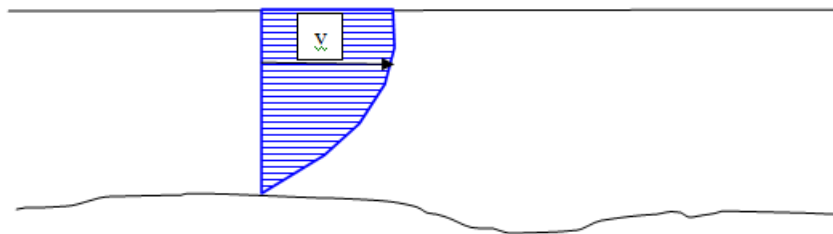
Figura 3 – Distribución simplificada del perfil de velocidades en el lecho del río Pilcomayo (Salta-Argentina).
