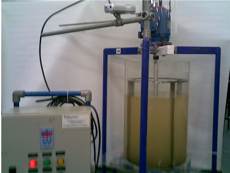
Figura 3: Escala piloto ( V = 48 \ell ), motor en balancín sobre rodamientos activado por inversor de frecuencia.
