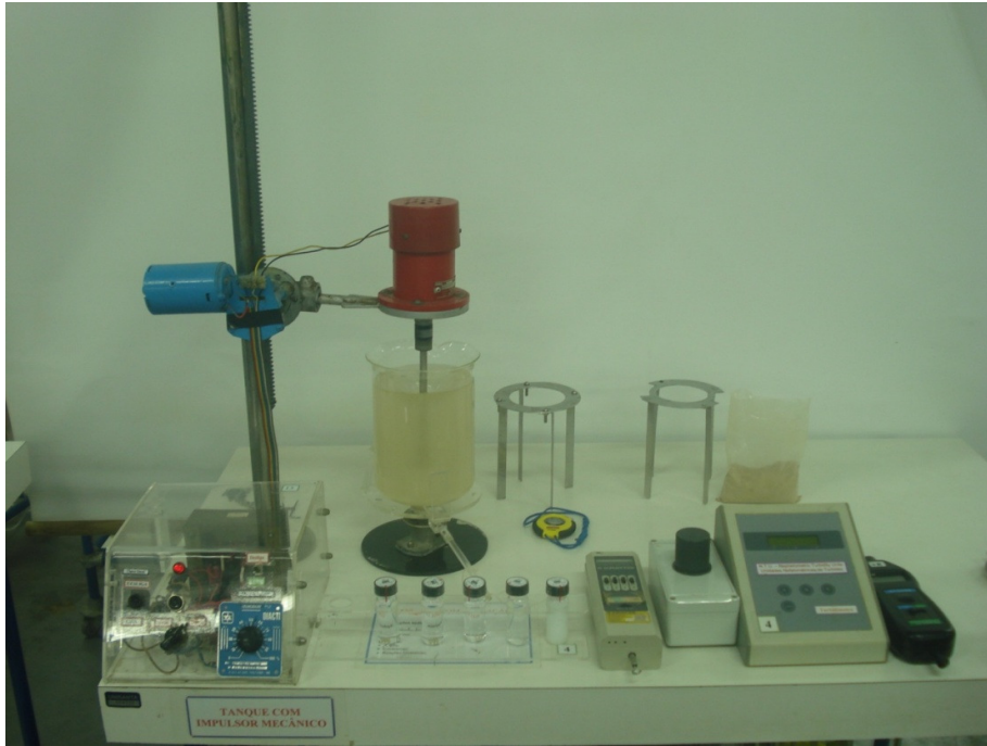
Figura 1: Escala de bancada ( V = 1,5 \ell ), estanque en balancín sobre rodamientos para el cálculo de la potencia
