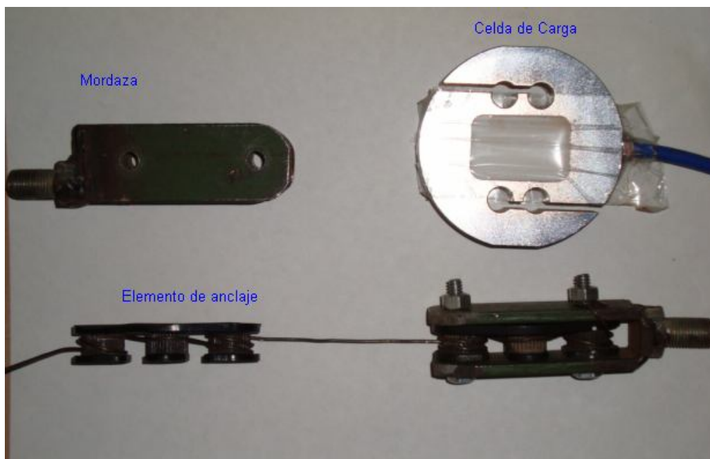
Figura 4. Mordazas y celda de carga
