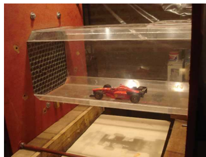
Figura 1: Vista del túnel de Viento didáctico de la Facultad de Ingeniería de la UNCo.
