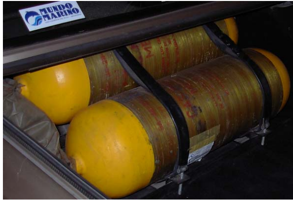
Figura 1: Cilindros de GNC Tipo 2 (acero PRFV) montados en un vehículo.
