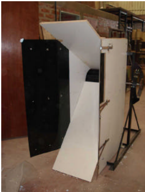
Fotografía 2: Aductor que acelera y guía al flujo de aire hacia los alabes de la turbina.
