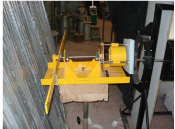
Fotografía 4: Medidor de torque consistente en un brazo de palanca acoplado al eje de la turbina por fricción.
