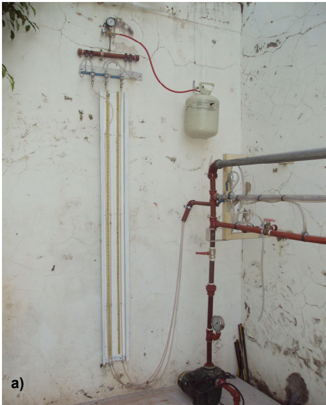
Figura 5 a) Detalle del arreglo de contrapresión para medición por columna de líquido (agua) de diferencias de presión entre presiones elevadas. b) Ampliación del sector donde se encuentra la válvula exclusiva y las tomas de presión aguas abajo y arriba de la misma
