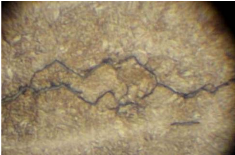
Figura 4: grietas preponderantemente intergranulares, matriz de martensita revenida, metalografía con ataque X391.
