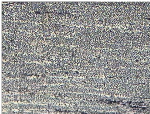
Figura 5: Microestructura del aluminio a agujerear (500X).
