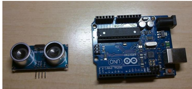
Figura 3: Placa Arduino UNO™ y sensores de posición ultrasónicos HC-SR04.
