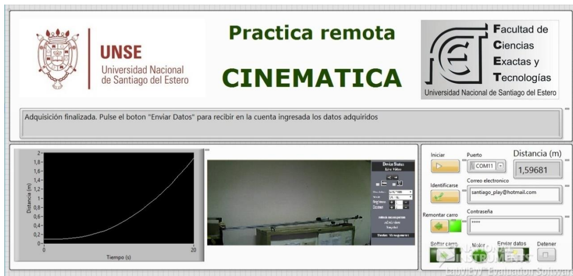
Figura 6: Interfaz gráfica para el control y monitoreo del laboratorio remoto
