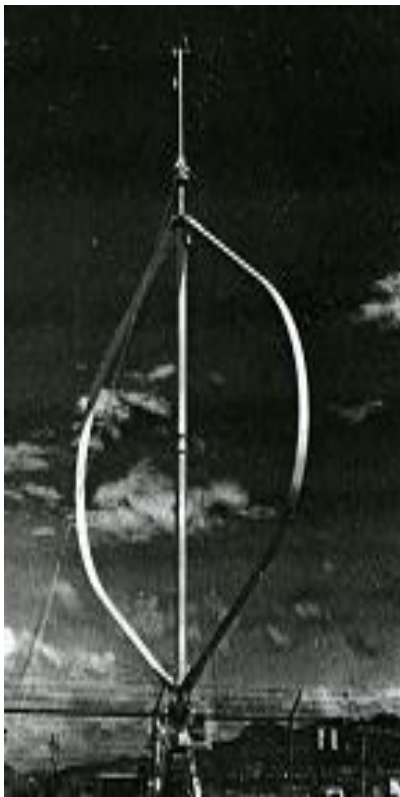
Figura 2 Turbina Darrieus Troposkien
